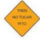
(P-44B) SEÑAL DE CRUCE FERROVIARIO A NIVEL "NO TOCAR PITO"
