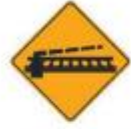
(P-43) SEÑAL CRUCE FERROVIARIO A NIVEL CON BARRERAS
