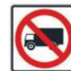
(R-19) SEÑAL DE PROHIBIDO CIRCULACIÓN DE VEHICULOS DE CARGA
