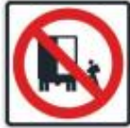
(R-52) SEÑAL PROHIBIDO LA CARGA Y DESCARGA
