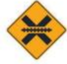
(P-42) SEÑAL CRUCE FERROVIARIO A NIVEL SIN BARRERAS
