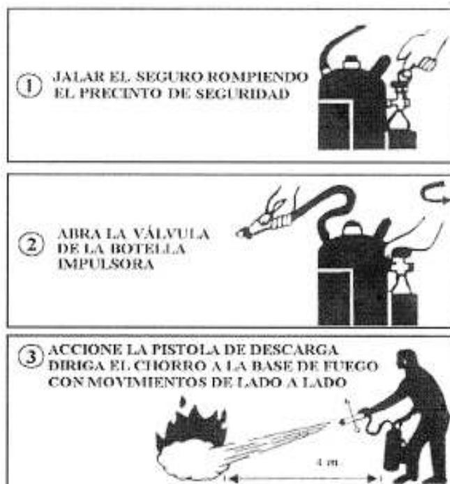
FIGURA 10 – Ejemplo de instrucciones de uso de extintor con botella impulsora
