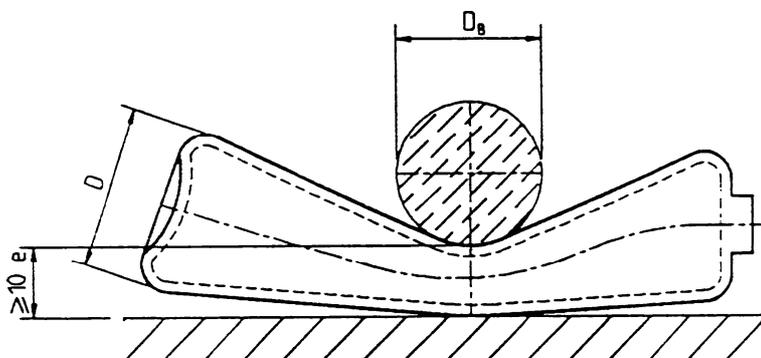
**FIGURA 6 – Ensayo de resistencia o aplastamiento**
