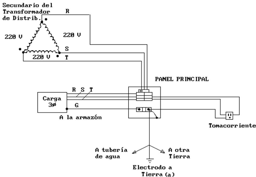
Nota.- El Panel Principal que se muestra contiene interruptores de protección contra sobrecorriente, puede usarse fusibles para la protección.
