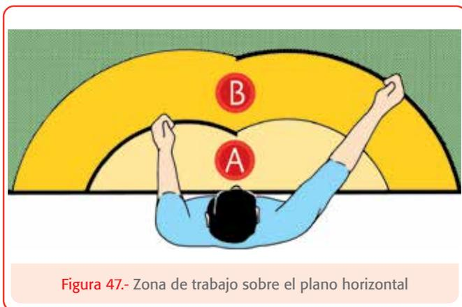
Figura 47.- Zona de trabajo sobre el plano horizontal
